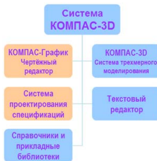
Рис. 1 - Блок-схема основних компонентів системи КОМПАС-3D
